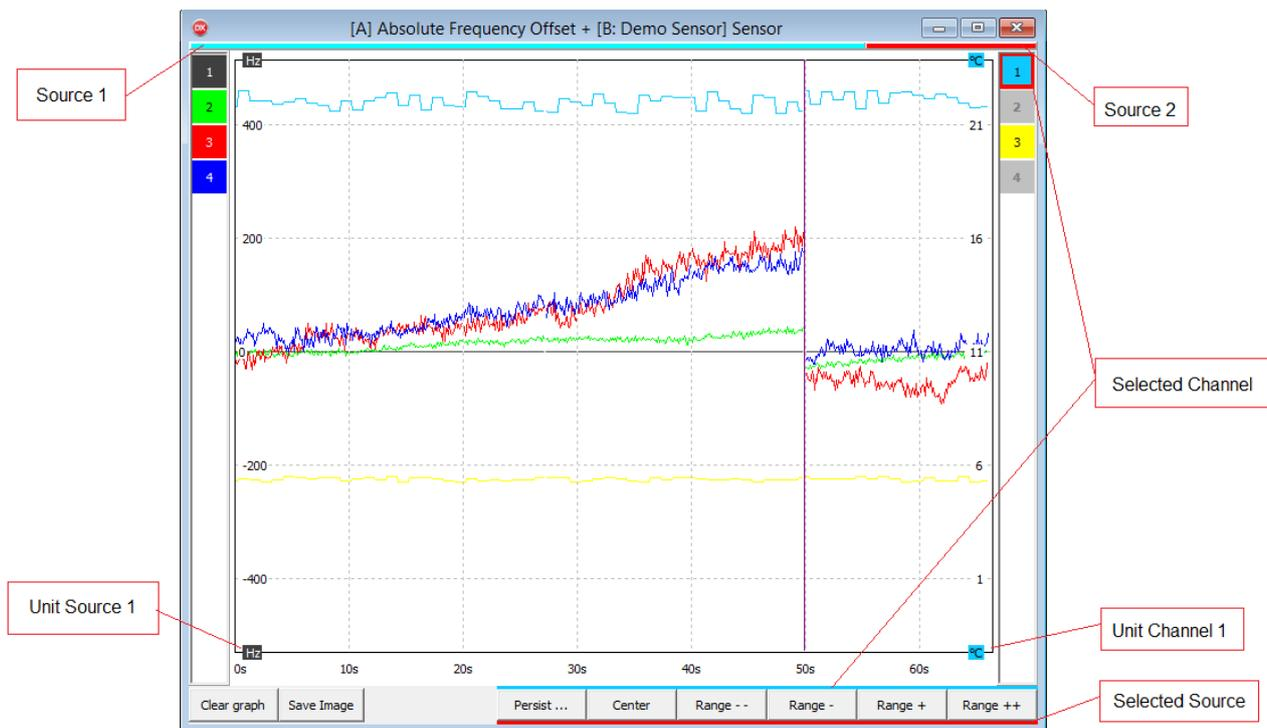
Für die zweite Source wird rechts zusätzlich die Kanalauswahl und Skalierung dieser Source dargestellt. Da es Geräte gibt, die unterschiedliche Messgrößen liefern können (z.B. Sensoren für Temperatur und Luftfeuchtigkeit), kann auch die Skalierung für die einzelnen Kanäle getrennt eingestellt werden.
