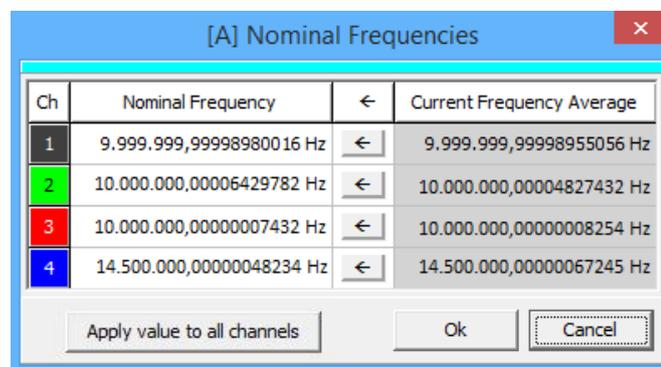
Für jeden Kanal kann eine ideale Frequenz (Nominalfrequenz) definiert werden, die für das Phasen-Residuum (Abweichung der Phase vom Idealwert) oder die Relativfrequenz in Relation zum Idealwert verwendet wird. Der Wert kann eingegeben oder ein Schätzwert übernommen werden.
