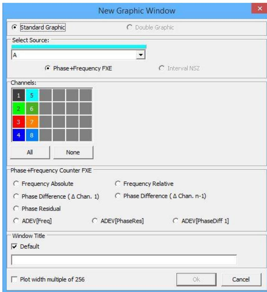
Es können Daten von nur einer Source (Standard Graphic, Skalen-Beschriftung links) oder von zwei Quellen (Double Graphic, Skalen-Beschriftung links und rechts) dargestellt werden.
