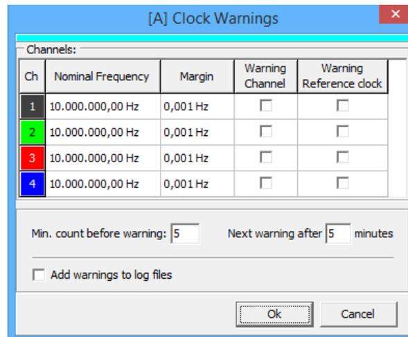
Erzeugung von Warnungen, wenn die gemessenen Frequenzen oder der Referenztakt einen vorgegebenen Bereich verlassen. Da eine Referenztakt-Abweichung nicht direkt gemessen werden kann, werden dazu mindestens 2 Eingangsfrequenzen überwacht. Zeigen diese gleichzeitig Abweichungen, wird eine Referenztakt-Warnung erzeugt.
