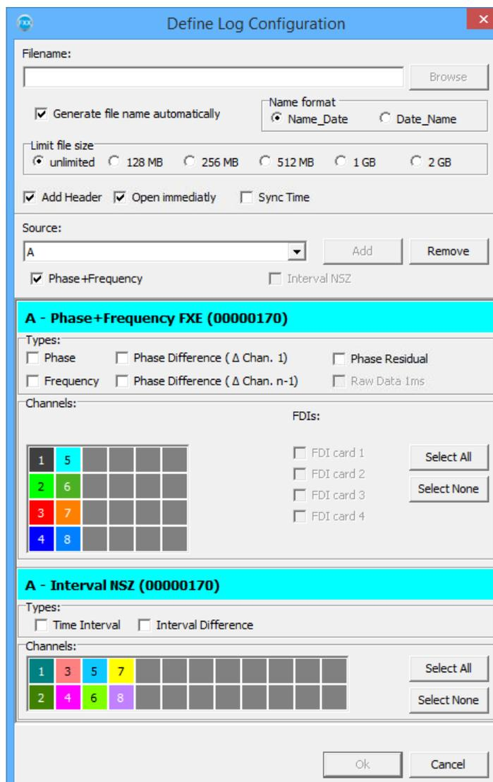
Der Dateiname kann automatisch generiert werden und setzt sich dann aus Source, Type und Datum zusammen; das Datum kann vor oder hinter dem Namen stehen. Außerdem kann die Dateigröße begrenzt werden; dann wird bei Erreichen der Maximalgröße eine neue Log-Datei begonnen.
