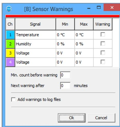
Erzeugung von Warnungen, wenn ein Sensor einen Minimal- bzw. Maximalwert unter- bzw. überschreitet.
