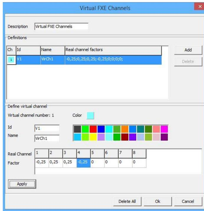
Definition von „Virtuellen Kanälen“, d.h. Linearkombinationen aus den Eingangsdaten - im Beispiel  $0,25 * (-Ch1+Ch2+Ch3-Ch4)$ . Die virtuellen Kanäle können in Text- und Grafik-Fenstern dargestellt und in Protokolldateien ausgegeben werden.
