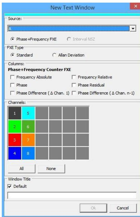
Unter „Channels“ werden die dargestellten Kanäle ausgewählt. Falls virtuelle Kanäle definiert wurden, können auch diese gewählt werden. Die Auswahl kann aber auch im Fenster selbst vorgenommen werden.
