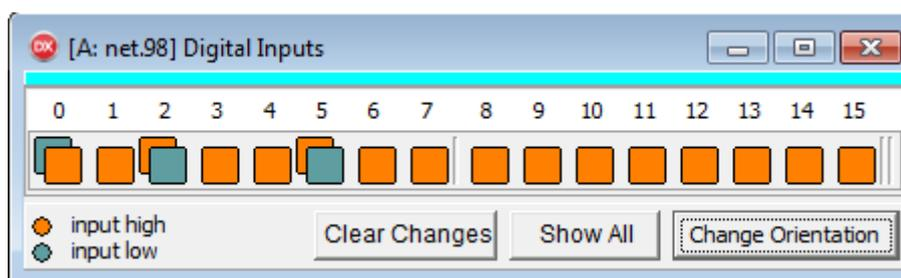
Durch Klicken auf ein Doppelquadrat kann diese Änderungsanzeige gelöscht, d.h. wieder auf ein Quadrat mit dem aktuellen Status zurückgekehrt werden. Ein weiterer Klick löscht die Darstellung dieses Eingangs aus der Liste; dies kann über die Funktion „Show All“ rückgängig gemacht werden. Mit der Funktion „Clear Changes“ werden alle Doppelquadrate gelöscht. Darüber hinaus kann mit „Change Orientation“ zwischen einer waagerechten und einer senkrechten Darstellung gewählt werden.
